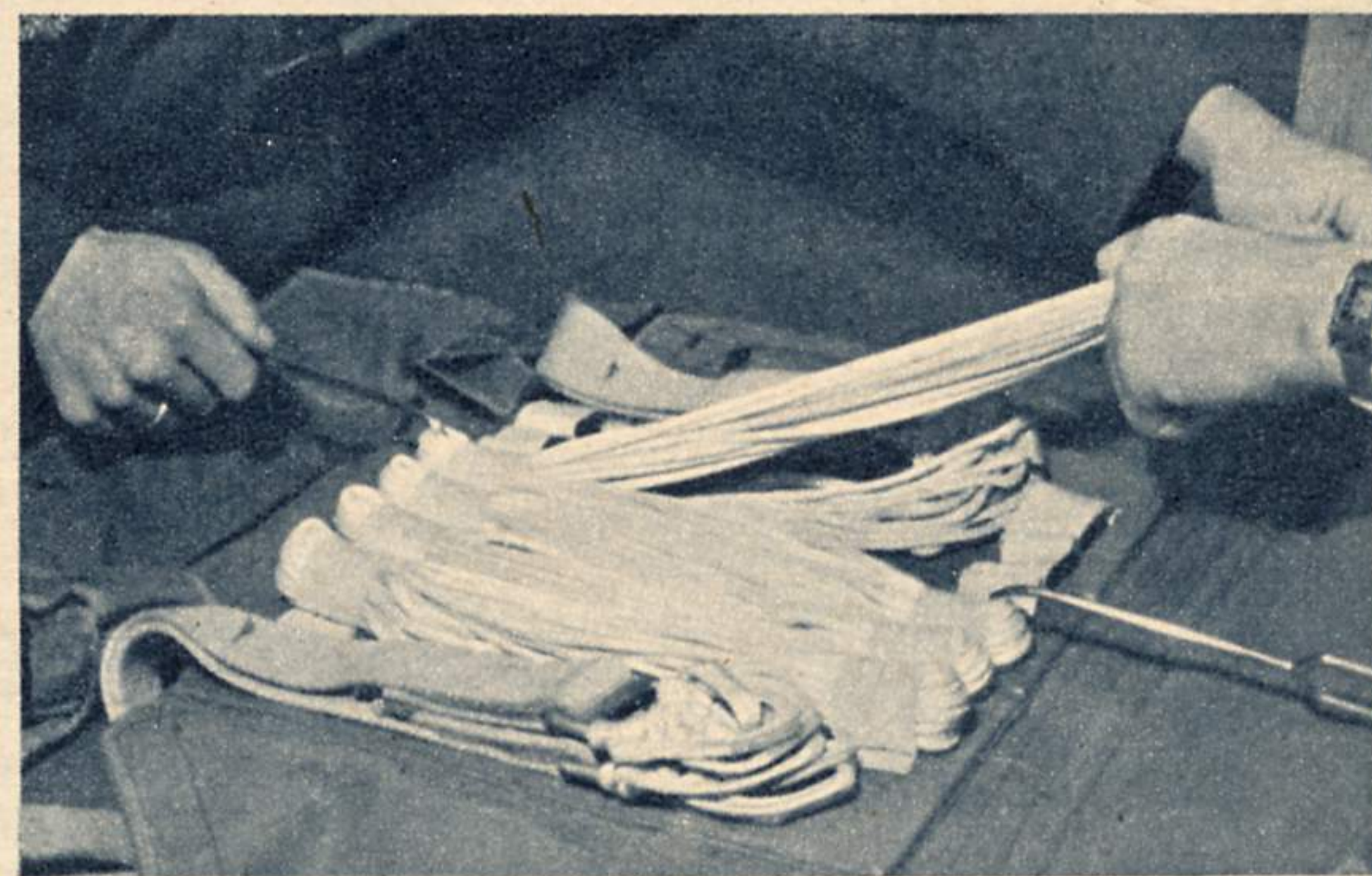
Jetzt werden die Fangleinen in den Fallschirmsack eingezogen
