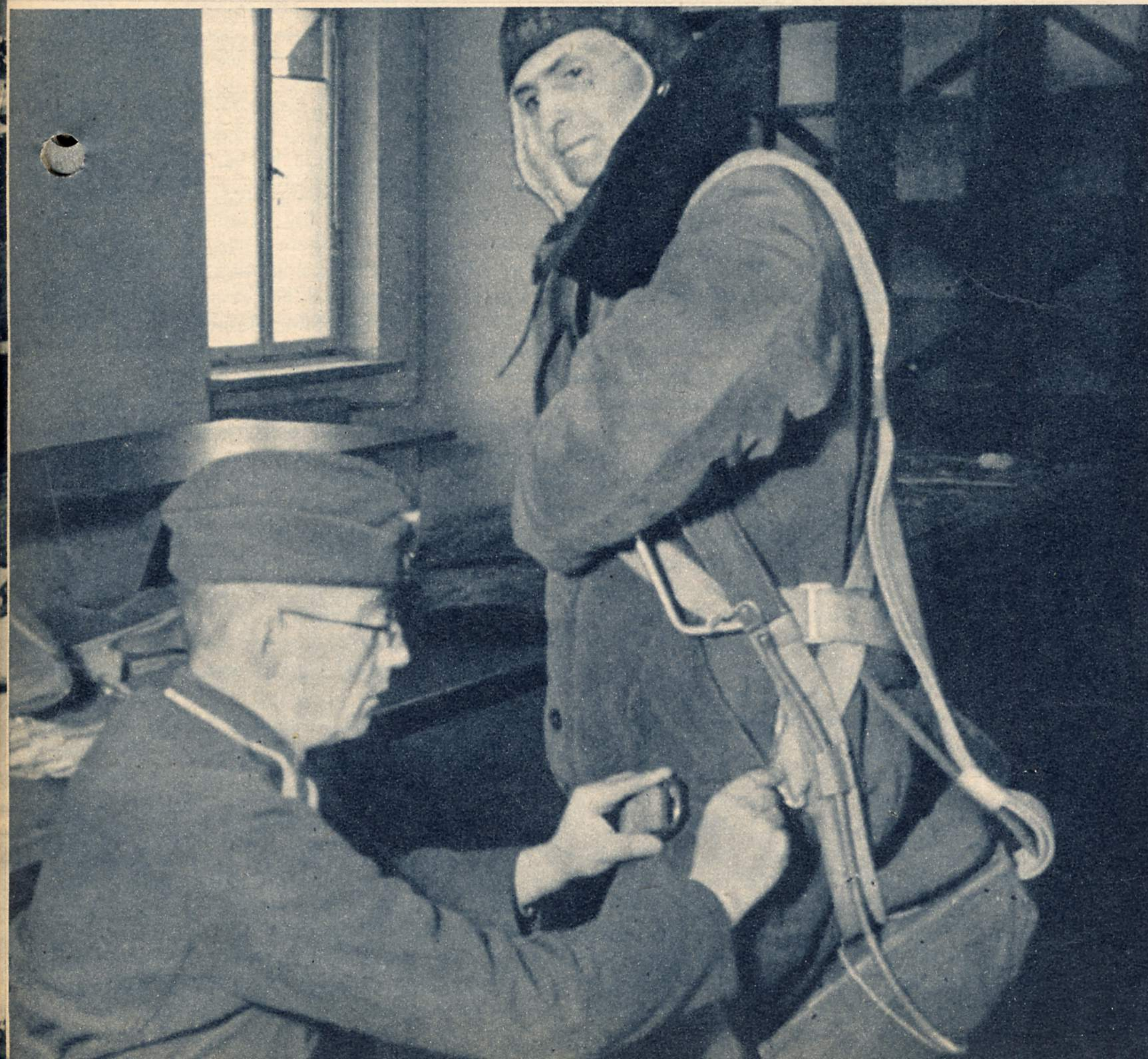
Zum Bilde rechts: Die Fangleinen, die einzige Verbindung zwischen Fallschirm und Flieger, werden vor dem Einbringen in den Fallschirmsack aufs sorgfältigste gelegt Aufn. Presse-Bild-Zentrale (8)
