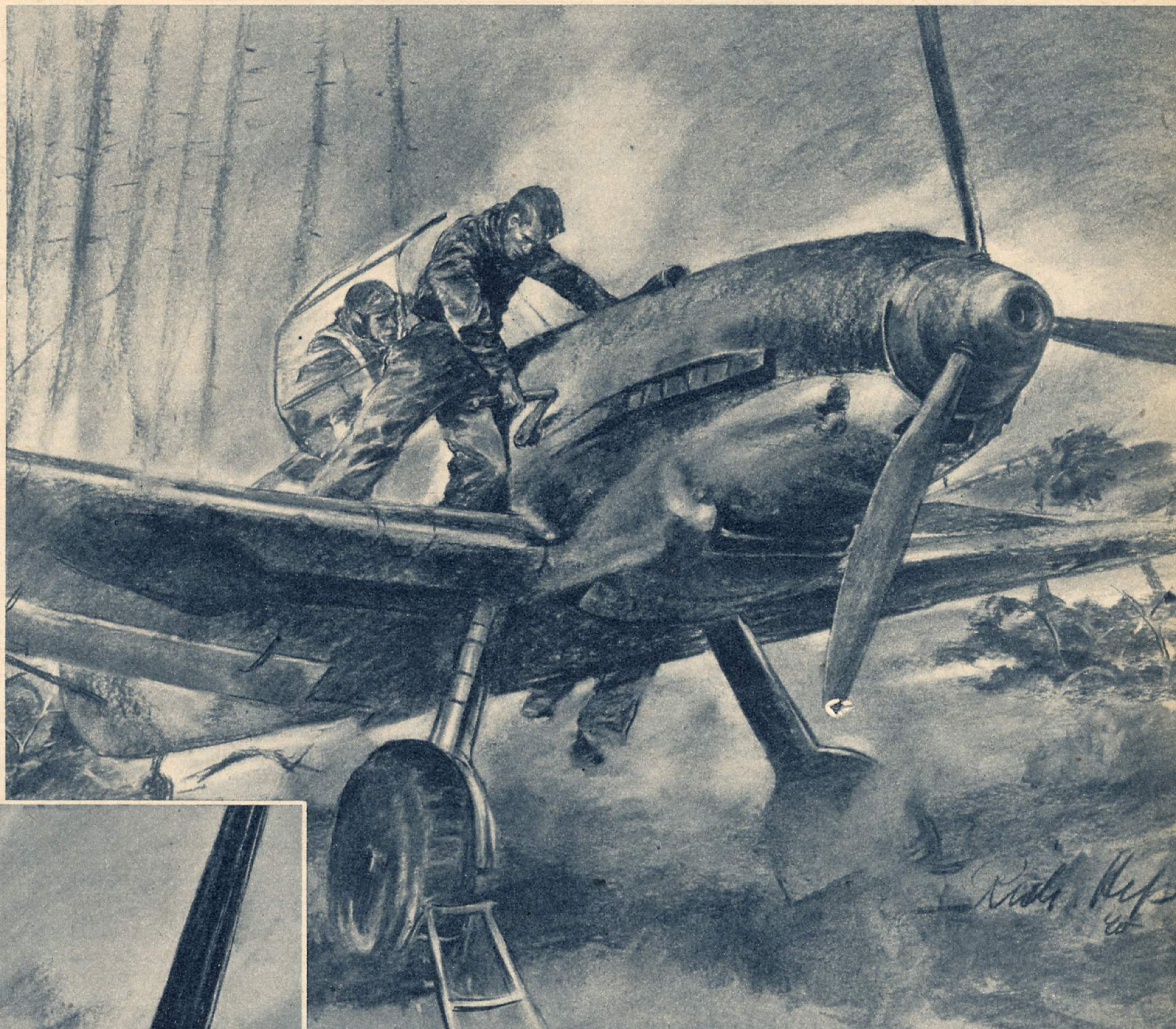
Auf einem Flugplatz im Westen wird ein Messerschmitt-Jagdflugzeug startklar gemacht. Während der Flugzeugführer im Führersitz Platz nimmt, dreht der Motorenwart die Anlaßkurbel, um den Motor anzuwerfen
