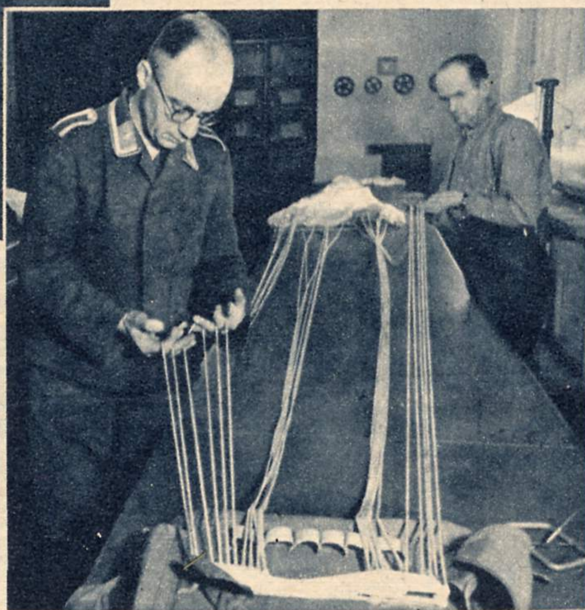
Zum Bilde rechts: Die Fangleinen, die einzige Verbindung zwischen Fallschirm und Flieger, werden vor dem Einbringen in den Fallschirmsack aufs sorgfältigste gelegt Aufn. Presse-Bild-Zentrale (8)
